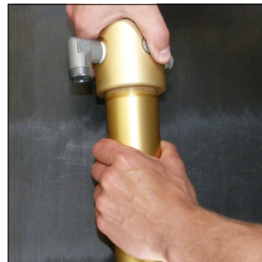
Abb. 1 - Oberteil abschrauben und abnehmen
