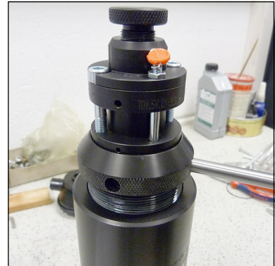
Abb. 1 - Filterdeckel abdrehen/ eindreuen
