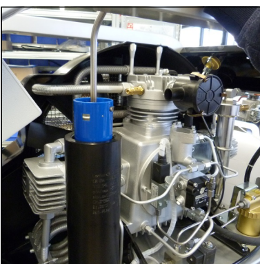
Abb. 2 - Filterpatrone mit Filterschlüssel entnehmen
