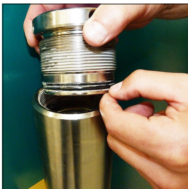
Abb. 2 - O-Ring und Stützring wechseln
