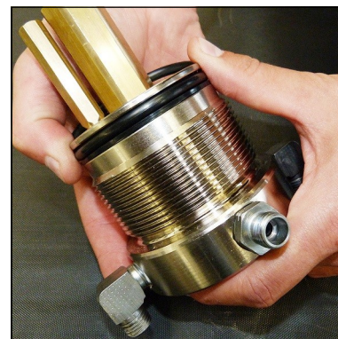
Abb. 4 - O-Ring und Stützring wechseln
