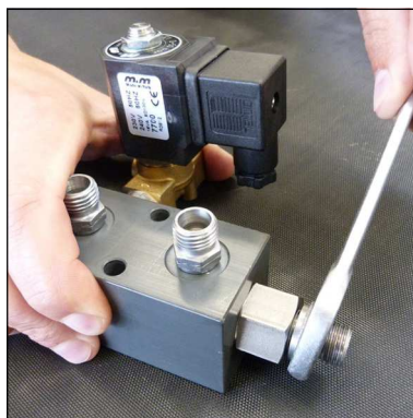
Abb. 2 - Gerade Verschraubung lösen
