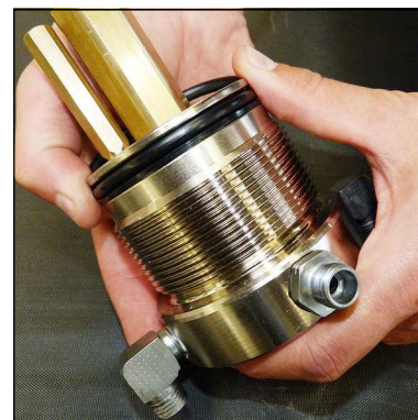
Abb. 4 - O-Ring und Stützring wechseln
