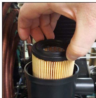
Deckel des Filtergehäuses demontieren und Filterpatrone wechseln
