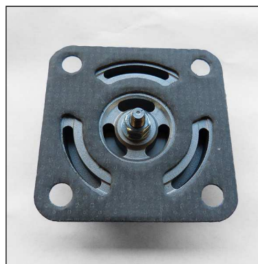
Auf korrekte Platzierung der Papierdichtung achten!
