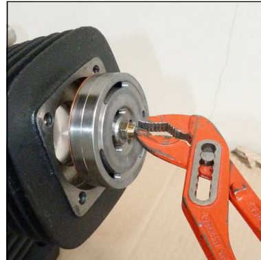
Saug- / Druckventil herausziehen
