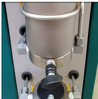
Abb. 3 - Rohrleitungsver-schraubungen und Muttern lösen
