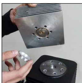
Abb. 2 Untere Ventildichtung entfernen
