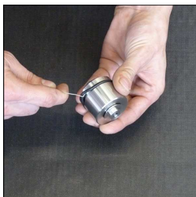
Abb. 3 - O-Ring wechseln (Kondensat-Stopp-Ventil)
