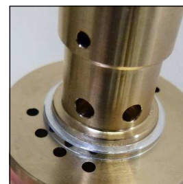
Abb. 4 Auf korrekte Einbauposition des oberen Ventildichtrings achten
