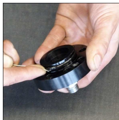
Abb. 4 - O-Ring wechseln (Deckel Kondensat-Stopp-Ventil)
