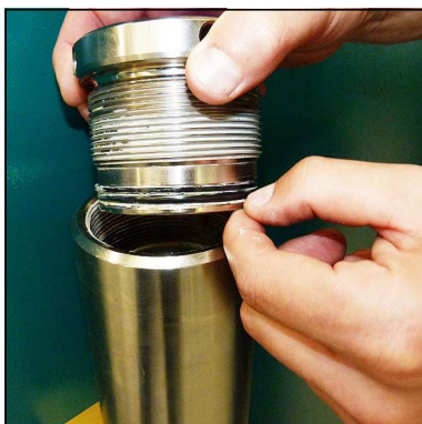
Abb. 2 - O-Ring und Stützring wechseln
