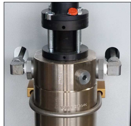
Abb. 1 - Rohrleitungen und Muttern lösen
