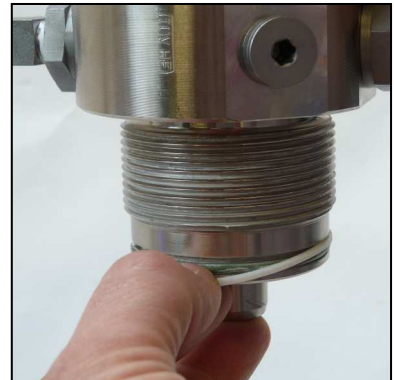
Abb. 1 - O-Ring und Stützring wechseln
