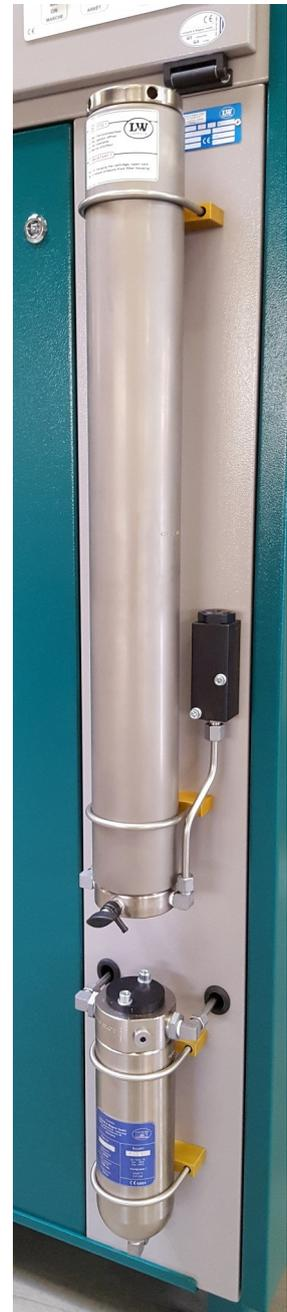
Filtergehäuse 2,3l (oben), Druckhalte-Rückschlagventil u. Partikelfiltergehäuse 0,8l (unten)
