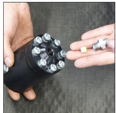
Abb. 5 - Sinterfilter wechseln
