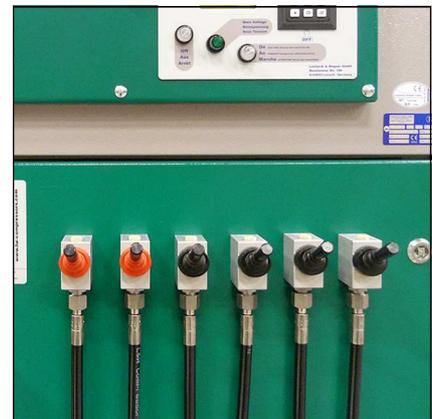
Fülleinrichtung am Kompressor
