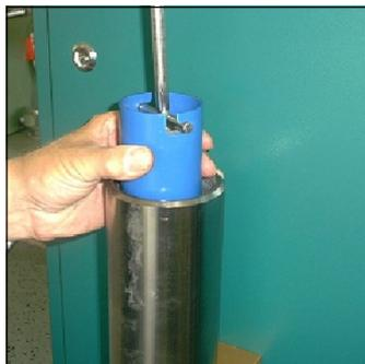
Abb. 4 - Filterpatrone aus dem Gehäuse entnehmen
