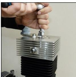
Abb. 1 Ventilkopfschrauben lösen
