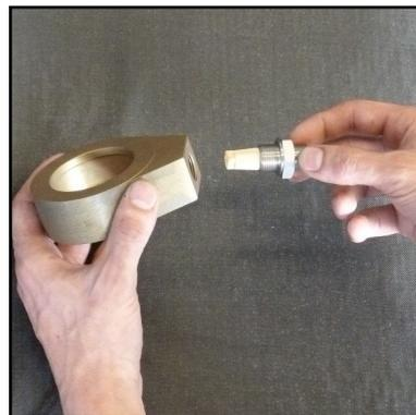
Abb. 8 - Sinterfilter wechseln
