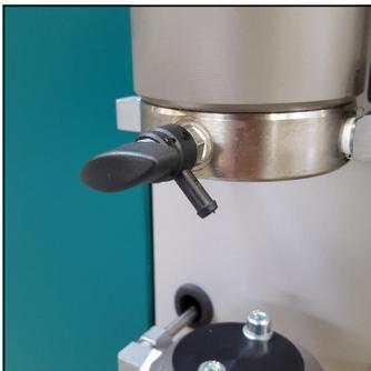
Abb. 1 - Kondensatventil Filterbehälter
