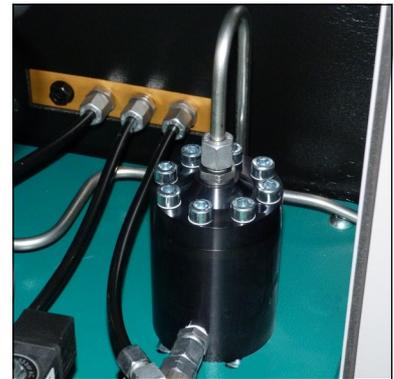
Abb. 1 - Kondensat-Stopp-Ventil-Gehäuse
