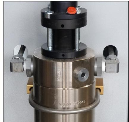
Abb. 1 - Rohrleitungen und Muttern lösen
