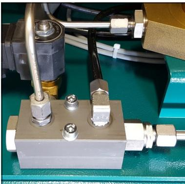
Abb. 1 - Pneumatisches Kondensatventil
