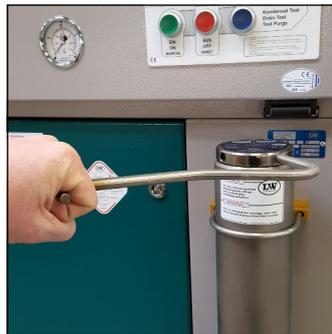
Abb. 2 - Abschrauben des Filtergehäuse-Deckels
