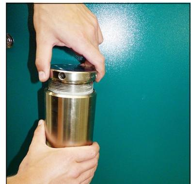
Abb. 1 - Filterdeckel öffnen
