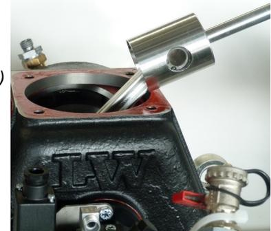
Abb. 2 - Kolben 3. Stufe
