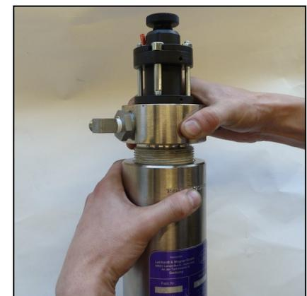
Abb. 3 - Filterdeckel öffnen
