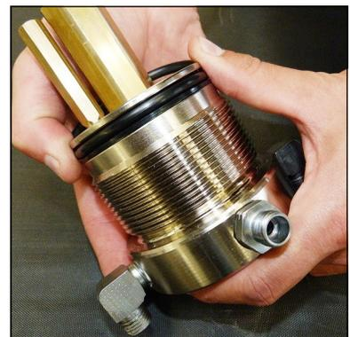
Abb. 4 - O-Ring und Stützring wechseln
