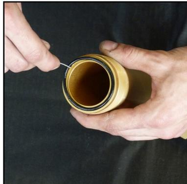
Abb. 5 - O-Ring wechseln
