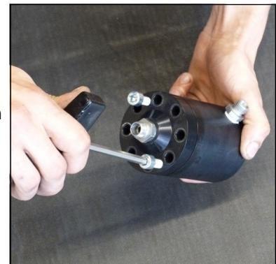
Abb. 2 - Kondensat-Stopp-Ventil-Oberteil abziehen
