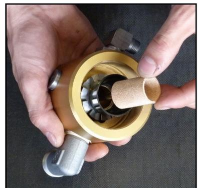
Abb. 3 - Sinterfilter wechseln
