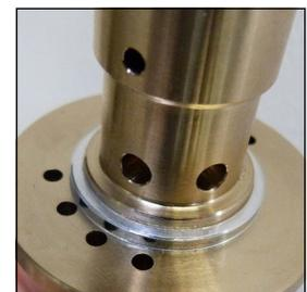
Abb. 4 Auf korrekte Einbauposition des oberen Ventildichtrings achten
