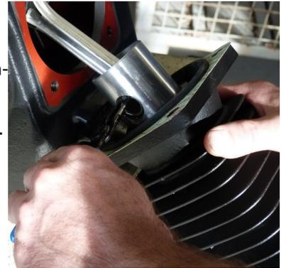
Abb. 1 - Kolbenmontage
