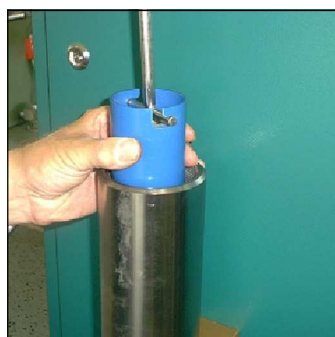
Abb. 4 - Filterpatrone aus dem Gehäuse entnehmen
