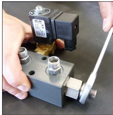
Abb. 2 - Gerade Verschraubung lösen
