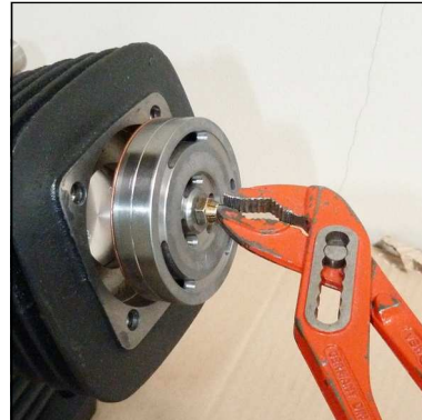
Abb. 2 - Saug- / Druckventil herausziehen
