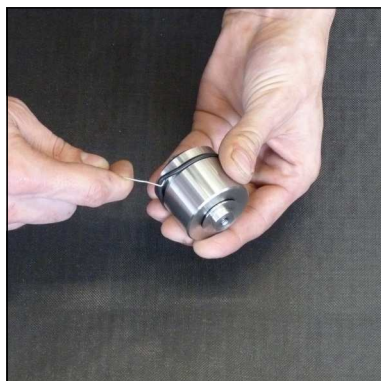
Abb. 3 - O-Ring wechseln (Kondensat-Stopp-Ventil)
