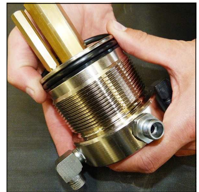
Abb. 4 - O-Ring und Stützring wechseln
