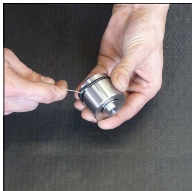
Abb. 3 - O-Ring wechseln (Kondensat-Stopp-Ventil)
