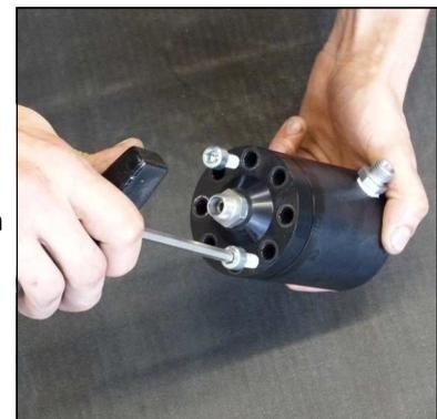
Abb. 2 - Kondensat-Stopp-Ventil-Oberteil abziehen
