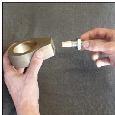
Abb. 8 - Sinterfilter wechseln
