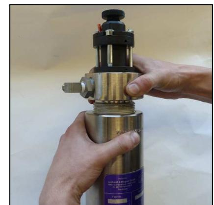
Abb. 3 - Filterdeckel öffnen
