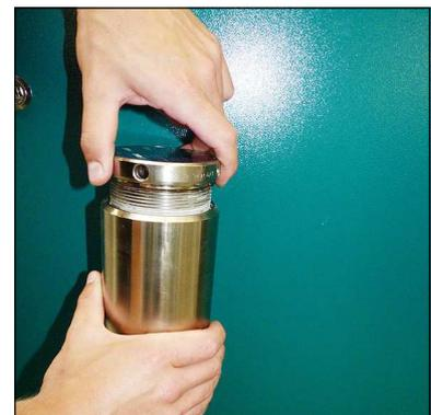
Abb. 1 - Filterdeckel öffnen
