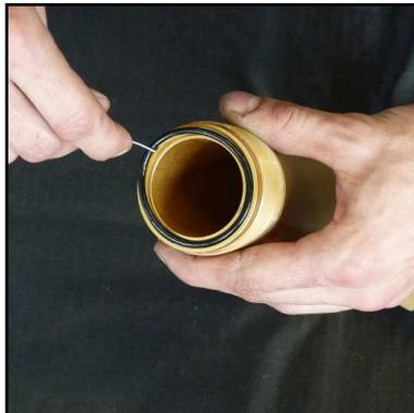
Abb. 5 - O-Ring wechseln
