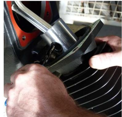
Abb. 1 - Kolbenmontage
