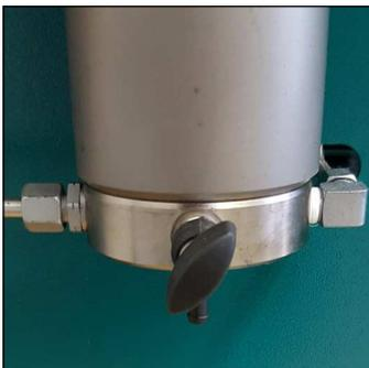
Abb. 1 - Kondensatventil
