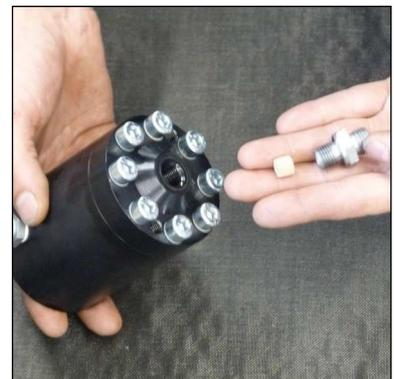
Abb. 5 - Sinterfilter wechseln
