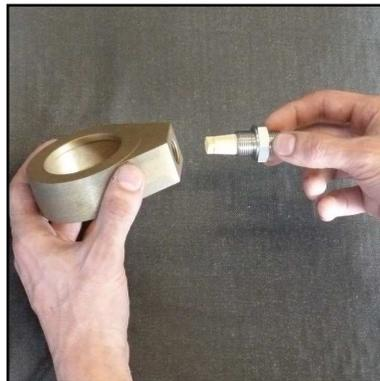
Abb. 8 - Sinterfilter wechseln
