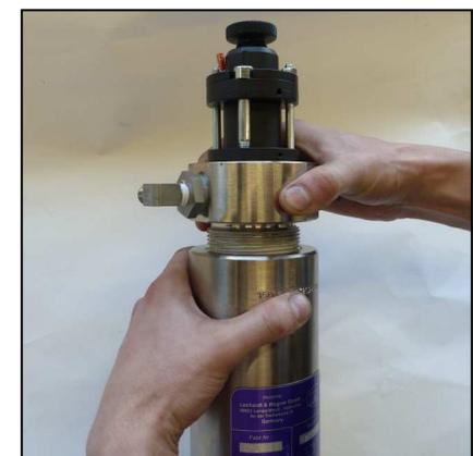
Abb. 3 - Filterdeckel öffnen
