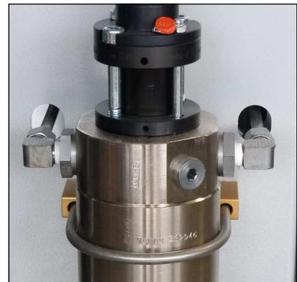
Abb. 1 - Rohrleitungen und Muttern lösen
