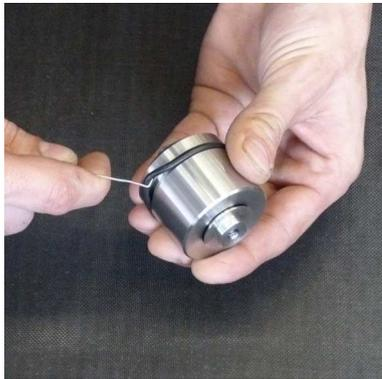
Abb. 4 - O-Ring wechseln am
