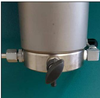
Abb. 1 - Kondensatventil
