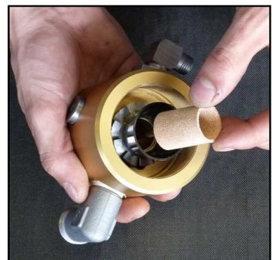
Abb. 3 - Sinterfilter wechseln
