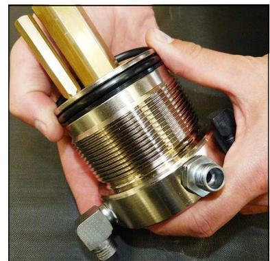
Abb. 4 - O-Ring und Stützring wechseln
