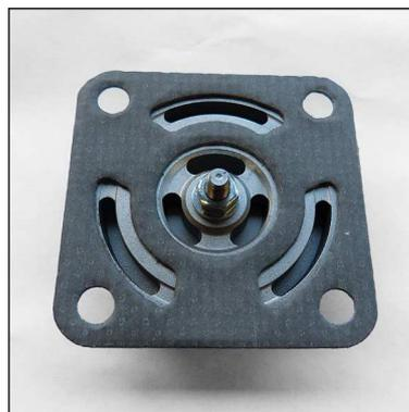
Abb. 4 - Auf korrekte Platzierung der Papierdichtung achten!
