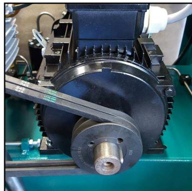
Abb. 2 - Antriebsmotor
