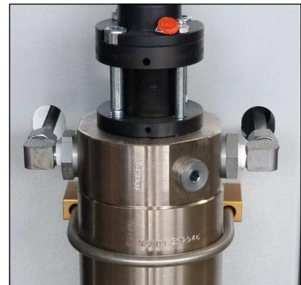
Abb. 1 - Rohrleitungen und Muttern lösen
