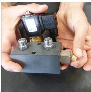
Abb. 3 - Sinterfilter wechseln
