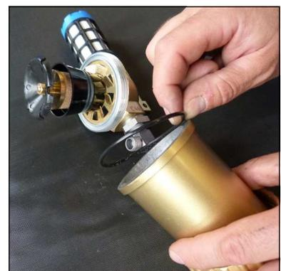
Abb. 3 - O-Ring wechseln
