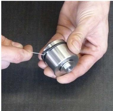
Abb. 4 - O-Ring wechseln am
