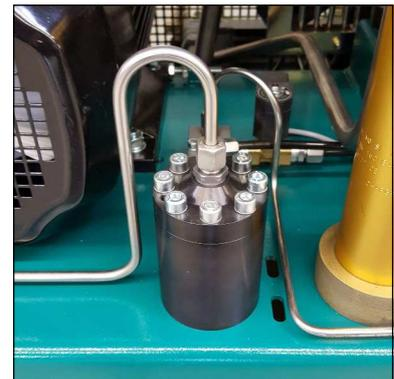
Abb. 1 - Kondensat-Stopp-Ventil-Gehäuse
