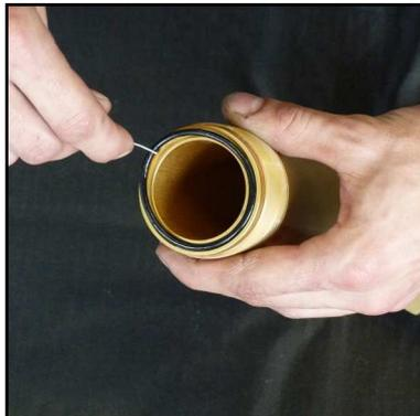
Abb. 5 - O-Ring wechseln
