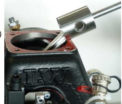
Abb. 2 - Kolben 3. Stufe
