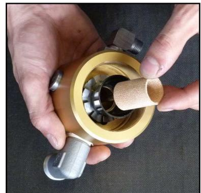
Abb. 3 - Sinterfilter wechseln
