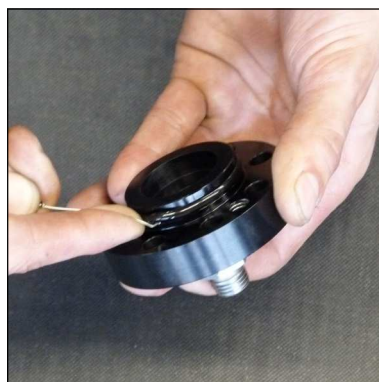
Abb. 4 - O-Ring wechseln (Deckel Kondensat-Stopp-Ventil)
