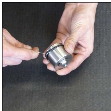
Abb. 3 - O-Ring wechseln (Kondensat-Stopp-Ventil)
