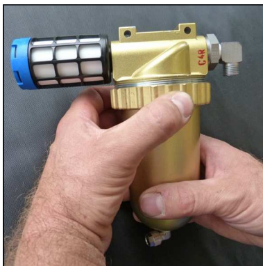
Fig. 1 - Loosen ring nut
