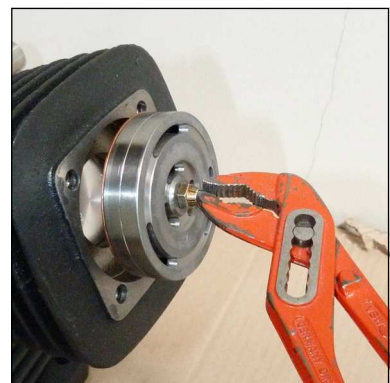
Abb. 2 - Saug- / Druckventil herausziehen
