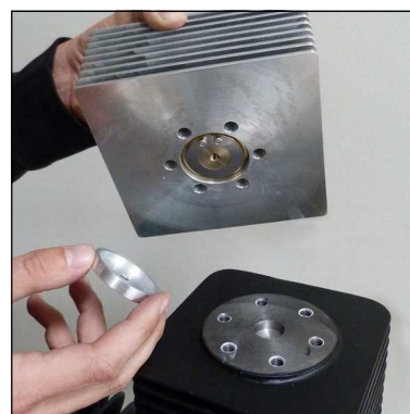
Abb. 2 - Untere Ventildichtung entfernen
