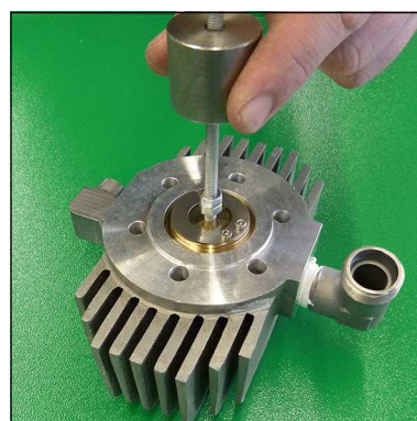
Abb. 4 - Saug / Druckventil ausbauen
