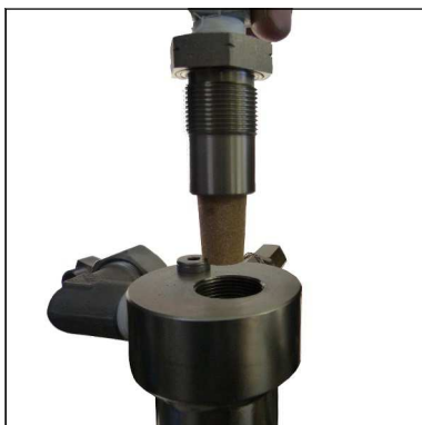
Abb. 2 - Halter für Sinterfilter entnehmen
