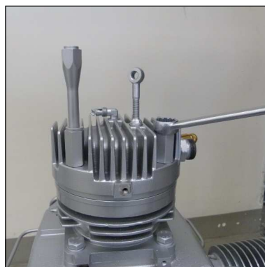
Abb. 6 - Untere Kühlrohrhalterung entfernen
