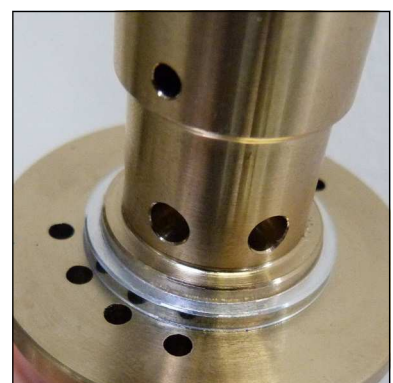
Abb. 5 - Auf korrekte Einbauposition des oberen Ventildichtrings achten
