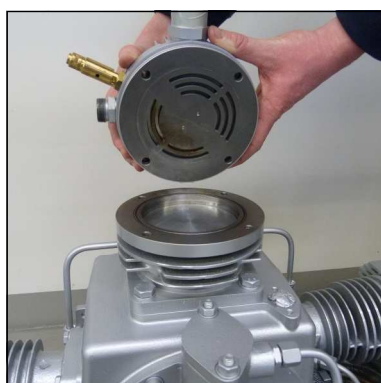
Abb. 3 - Einbauposition der Ventilplatte mit Ventilkopf
