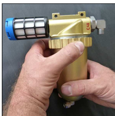
Fig. 1 - Loosen ring nut
