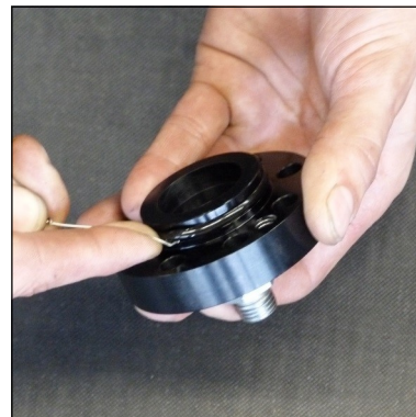
Abb. 4 - O-Ring wechseln (Deckel Kondensat-Stopp-Ventil)
