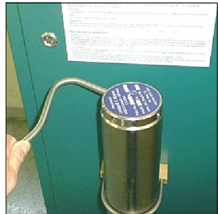
Abb. 1 - Abschrauben des Filtergehäuse-Deckels
