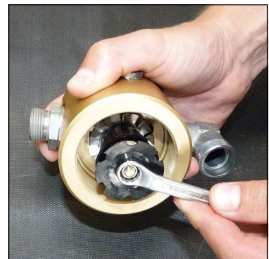
Abb. 2 - Mutter am Oberteil lösen
