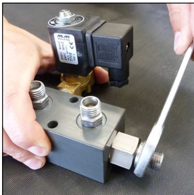
Abb. 2 - Gerade Verschraubung lösen
