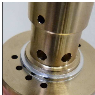
Abb. 4 - Auf korrekte Einbauposition des oberen Ventildichtrings achten
