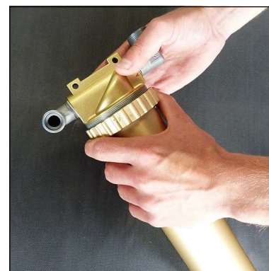
Abb. 1 - Gewinding öffnen und Oberteil abnehmen
