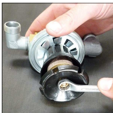
Abb. 2 - Mutter am Oberteil lösen
