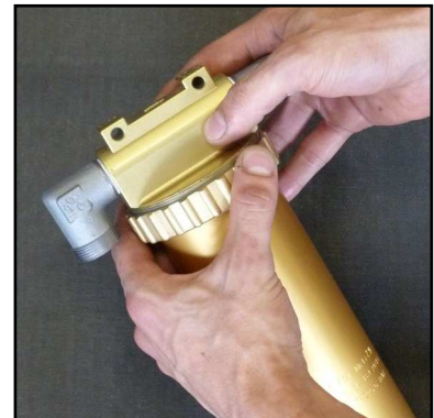
Abb. 1 - Gewinding öffnen und Oberteil abnehmen
