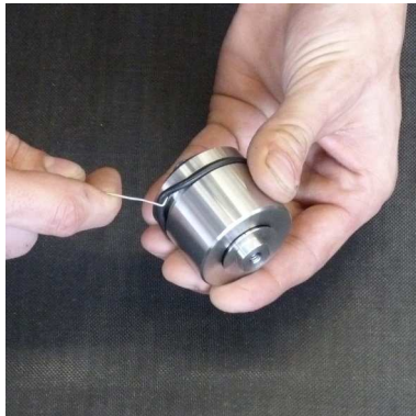
Abb. 4 - O-Ring wechseln am Kondensat-Stopp-Ventil
