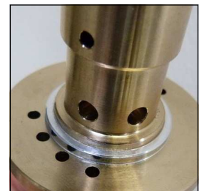
Abb. 4 Auf korrekte Einbauposition des oberen Ventildichtrings achten
