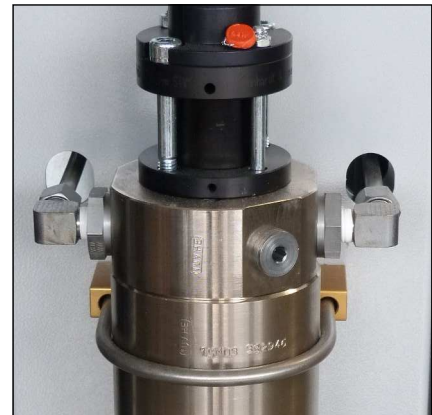
Abb. 1 - Rohrleitungsverschraubungen und Muttern lösen
