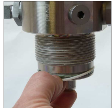
Abb. 2 - O-Ring und Stützring wechseln
