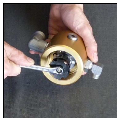
Abb. 2 - Mutter am Oberteil lösen
