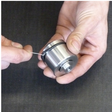
Abb. 4 - O-Ring wechseln am Kondensat-Stopp-Ventil
