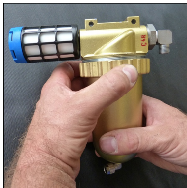
Fig. 1 - Loosen ring nut
