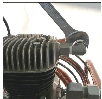
Abb. 6 - Rohrleitungsverschraubung anschließen und anziehen
