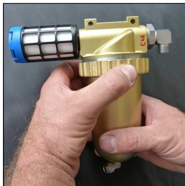
Fig. 1 - Loosen ring nut
