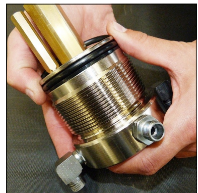
Abb. 4 - O-Ring und Stützring wechseln
