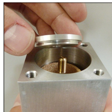
Abb. 5 - Filterscheibe und Unterlegscheibe aufsetzen
