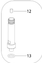
10 (DIN Füllanschluss 200bar / Filling Connection 200bar)
