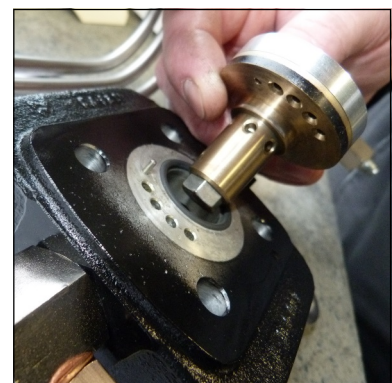
Abb. 5 - Auf Positionierung von Ventil achten (Zentrierstift)
