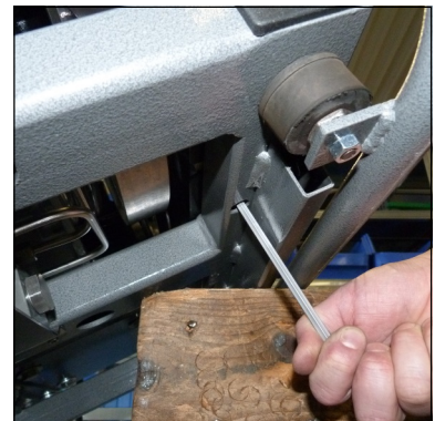
Abb. 3 - Befestigungsschrauben unten lösen
