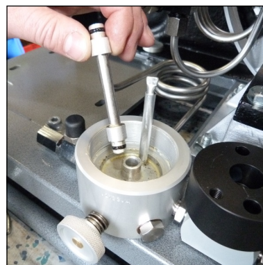
Abb. 5 - Verbindungsstutzen abziehen und O-Ringe wechseln
