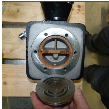
Abb. 2 - Auf korrekte Platzierung der oberen Dichtung achten!
