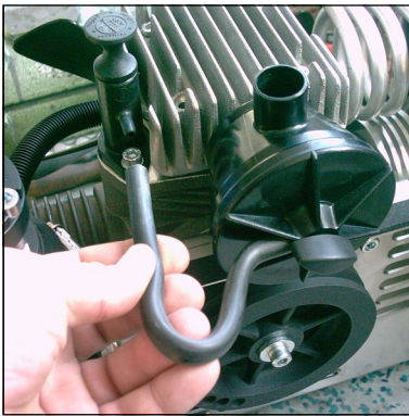
Abb. 1 - Entlüftungsschlauch am Öleinfüllstutzen abziehen
