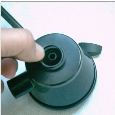
Abb. 4 - O-Ring in Zentrierbund einlegen
