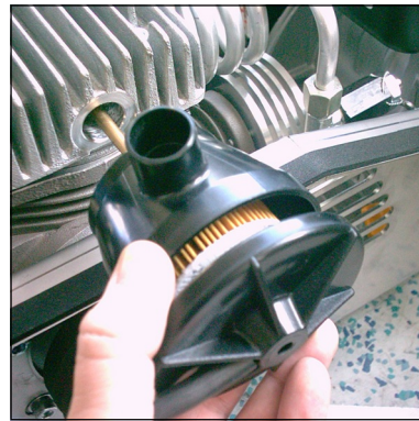
Abb. 2 - Filtergehäuse vorsichtig herausziehen
