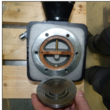
Abb. 2 - Saug- und Druckventil entnehmen
