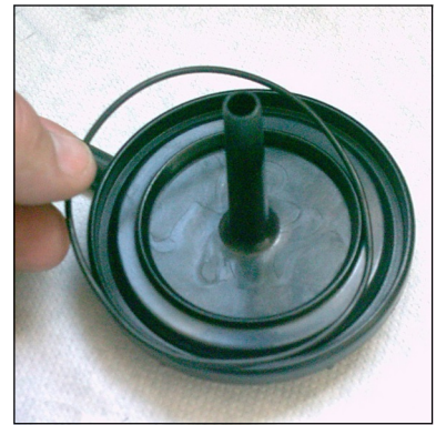
Abb. 3 - O-Ring in Gehäusedeckel einlegen
