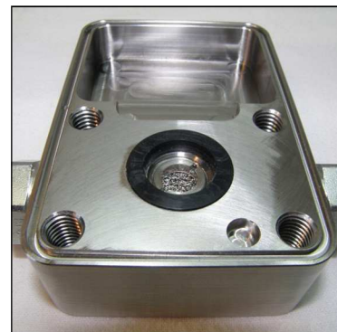
Abb. 4 - Unterteil Dichtring und Sinterfilter
