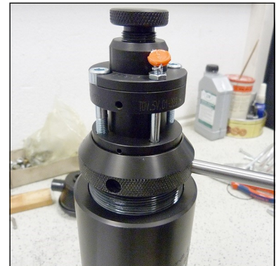
Abb. 1 - Filterdeckel abdrehen/ eindrehen
