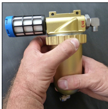
Fig. 1 - Loosen ring nut
