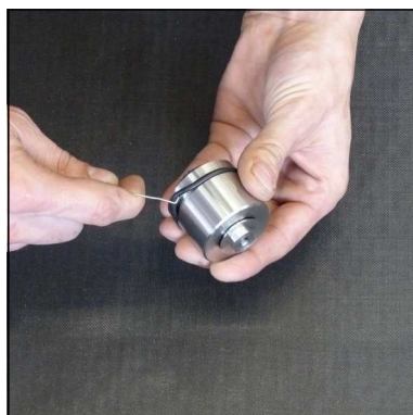
Abb. 3 - O-Ring wechseln (Kondensat-Stopp-Ventil)
