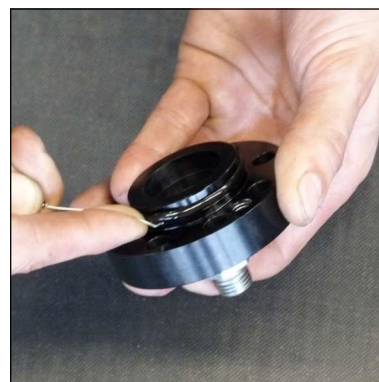
Abb. 4 - O-Ring wechseln (Deckel Kondensat-Stopp-Ventil)
