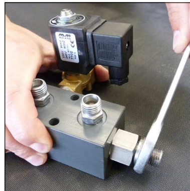
Abb. 2 - Gerade Verschraubung lösen
