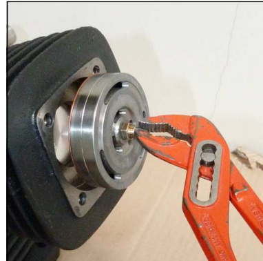
Saug- / Druckventil herausziehen
