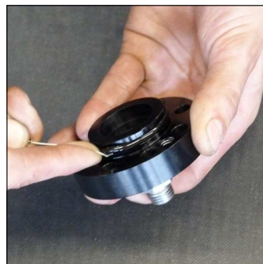
Abb. 4 - O-Ring wechseln (Deckel Kondensat-Stopp-Ventil)
