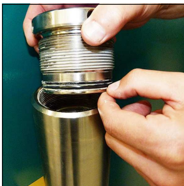
Abb. 2 - O-Ring und Stützring wechseln
