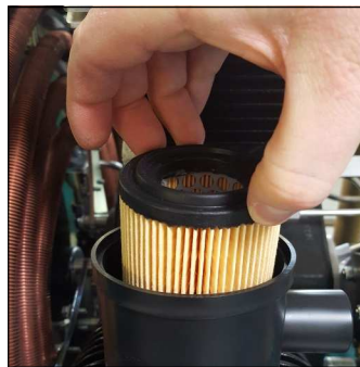
Deckel des Filtergehäuses demontieren und Filterpatrone wechseln
