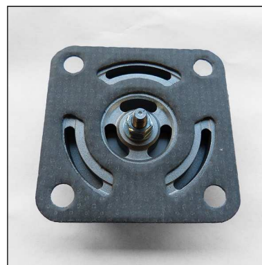
Auf korrekte Platzierung der Papierdichtung achten!
