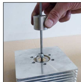
Abb. 3 Saug / Druckventil ausbauen
