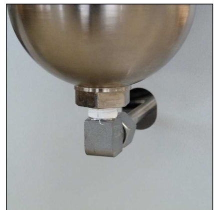
Abb. 2 - Rohrleitungen und Muttern lösen
