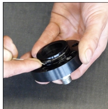
Abb. 4 - O-Ring wechseln (Deckel Kondensat-Stopp-Ventil)
