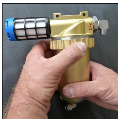
Fig. 1 - Loosen ring nut
