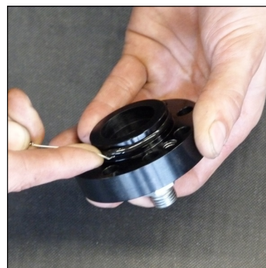
Abb. 4 - O-Ring wechseln (Deckel Kondensat-Stopp-Ventil)
