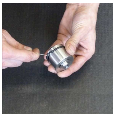
Abb. 3 - O-Ring wechseln (Kondensat-Stopp-Ventil)
