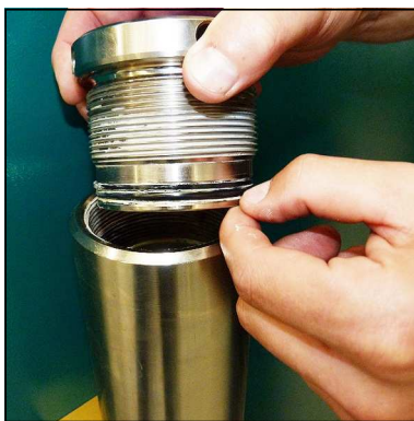
Abb. 2 - O-Ring und Stützring wechseln
