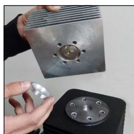
Abb. 2 Untere Ventildichtung entfernen
