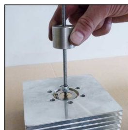
Abb. 3 Saug / Druckventil ausbauen
