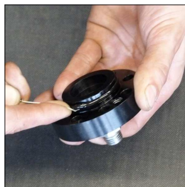
Abb. 4 - O-Ring wechseln (Deckel Kondensat-Stopp-Ventil)
