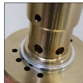
Abb. 4 Auf korrekte Einbauposition des oberen Ventildichtrings achten
