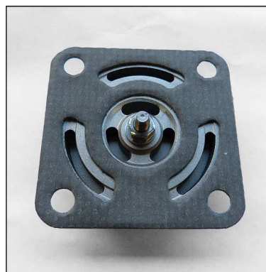
Abb. 4 - Auf korrekte Platzierung der Papierdichtung achten!
