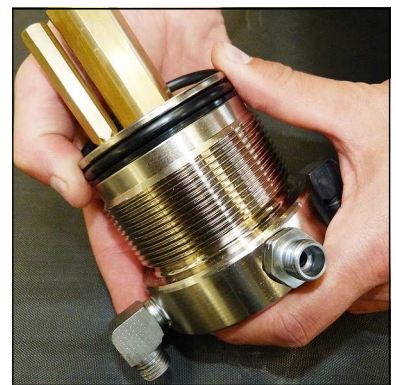
Abb. 4 - O-Ring und Stützring wechseln
