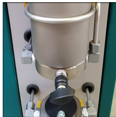
Abb. 3 - Rohrleitungsverschraubungen und Muttern lösen
