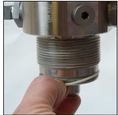
Abb. 1 - O-Ring und Stützring wechseln
