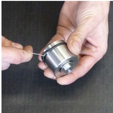
Abb. 4 - O-Ring wechseln am Kondensat-Stopp-Ventil
