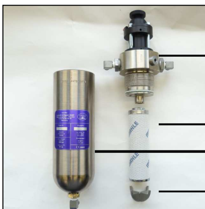
Abb. 4 - 0,8l Filterbehälter zerlegt
