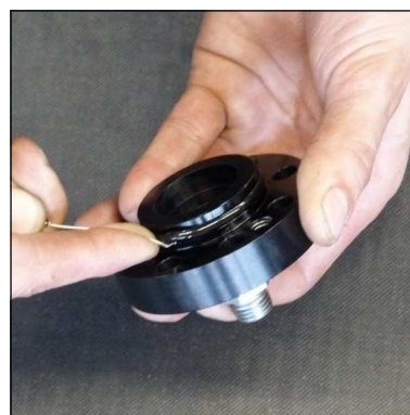
Abb. 4 - O-Ring wechseln (Deckel Kondensat-Stopp-Ventil)
