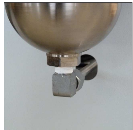
Abb. 2 - Rohrleitungen und Muttern lösen
