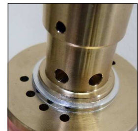
Abb. 4 Auf korrekte Einbauposition des oberen Ventildichtrings achten
