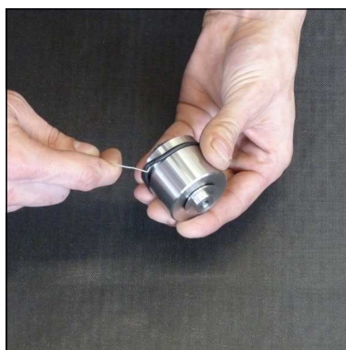
Abb. 3 - O-Ring wechseln (Kondensat-Stopp-Ventil)
