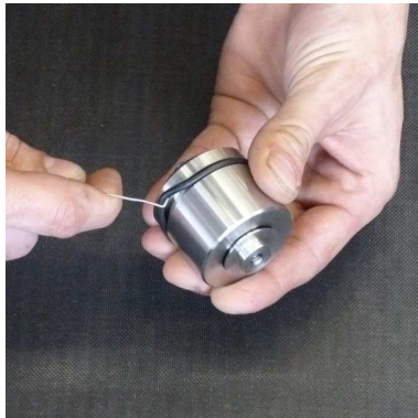
Abb. 4 - O-Ring wechseln am Kondensat-Stopp-Ventil
