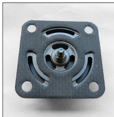
Abb. 4 - Auf korrekte Platzierung der Papierdichtung achten!
