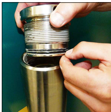
Abb. 2 - O-Ring und Stützring wechseln
