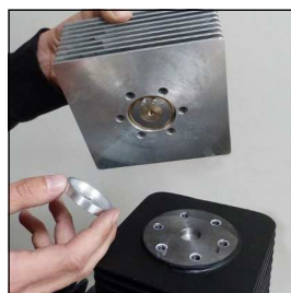
Abb. 2 Untere Ventildichtung entfernen
