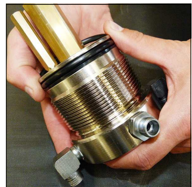
Abb. 4 - O-Ring und Stützring wechseln
