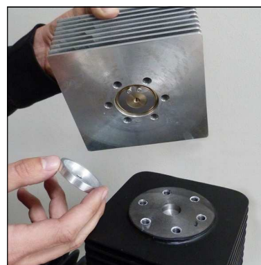
Abb. 2 - Untere Ventildichtung entfernen
