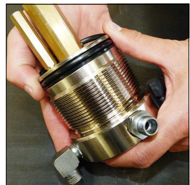
Abb. 4 - O-Ring und Stützring wechseln
