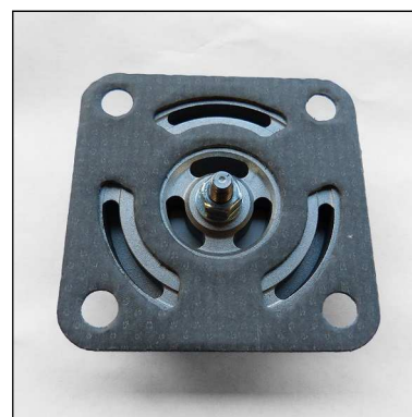
Abb. 4 - Auf korrekte Platzierung der Papierdichtung achten!
