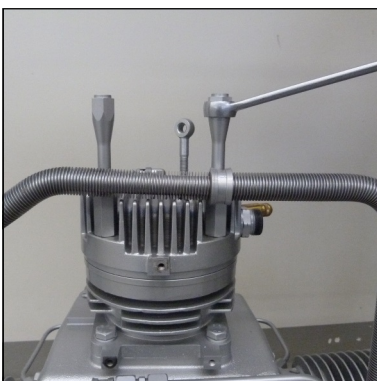
Abb. 5 - Obere Kühlrohrhalterung entfernen
