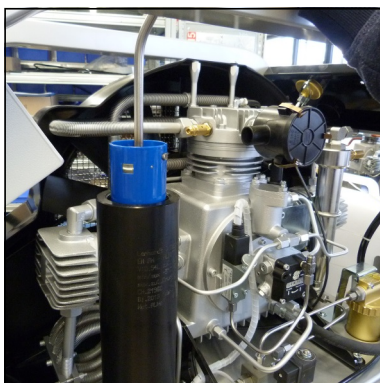
Abb. 2 - Filterpatrone mit Filterschlüssel entnehmen
