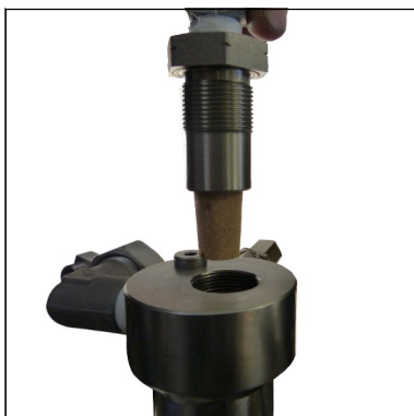
Abb. 2 - Halter für Sinterfilter entnehmen
