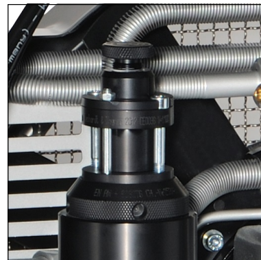
Abb. 1 - Filterdeckel abdrehen/ eindrehen
