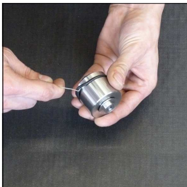
Abb. 3 - O-Ring wechseln (Kondensat-Stopp-Ventil)
