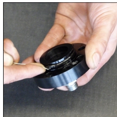
Abb. 4 - O-Ring wechseln (Deckel Kondensat-Stopp-Ventil)
