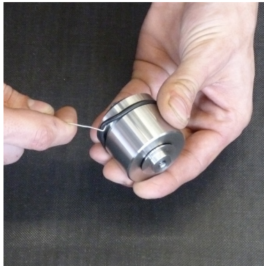
Abb. 4 - O-Ring wechseln am Kondensat-Stopp-Ventil
