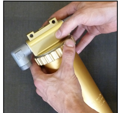
Abb. 1 - Gewinding öffnen und Oberteil abnehmen
