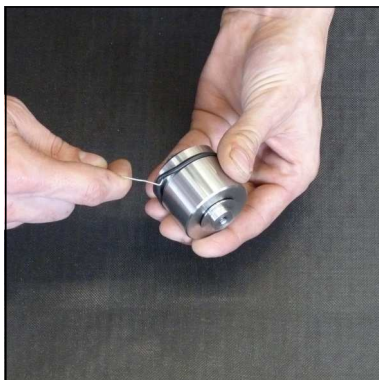
Abb. 3 - O-Ring wechseln (Kondensat-Stopp-Ventil)
