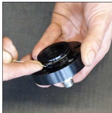
Abb. 4 - O-Ring wechseln (Deckel Kondensat-Stopp-Ventil)
