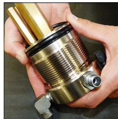
Abb. 4 - O-Ring und Stützring wechseln
