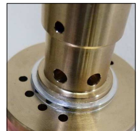
Abb. 4 Auf korrekte Einbauposition des oberen Ventildichtrings achten
