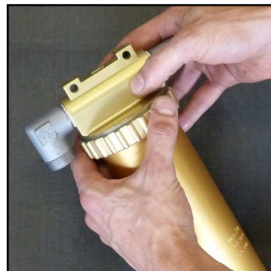
Abb. 1 - Gewinding öffnen und Oberteil abnehmen
