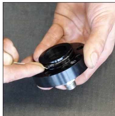
Abb. 4 - O-Ring wechseln (Deckel Kondensat-Stopp-Ventil)
