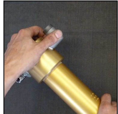
Abb. 1 - Oberteil abschrauben und abnehmen
