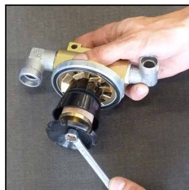
Abb. 2 - Mutter am Oberteil lösen
