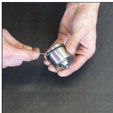
Abb. 3 - O-Ring wechseln (Kondensat-Stopp-Ventil)
