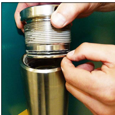
Abb. 2 - O-Ring und Stützring wechseln
