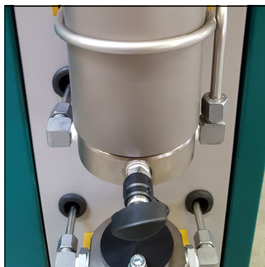
Abb. 3 - Rohrleitungsverschraubungen und Muttern lösen
