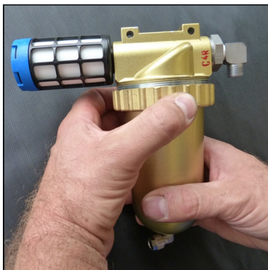
Fig. 1 - Loosen ring nut
