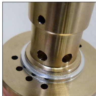
Abb. 4 - Auf korrekte Einbauposition des oberen Ventildichtrings achten
