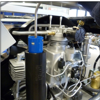
Abb. 2 - Filterpatrone mit Filterschlüssel entnehmen
