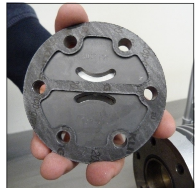
Abb. 2 - Einbauposition der oberen Ventildichtung
