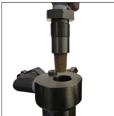
Abb. 2 - Halter für Sinterfilter entnehmen
