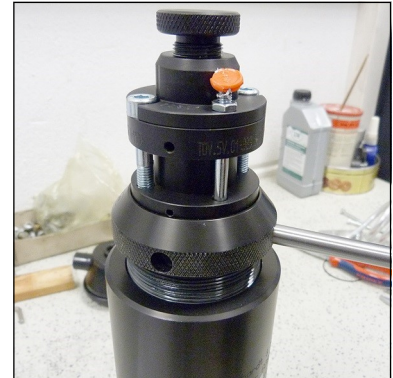
Abb. 1 - Filterdeckel abdrehen/ eindrehen
