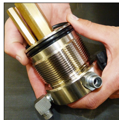
Abb. 4 - O-Ring und Stützring wechseln
