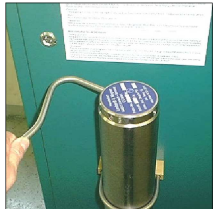
Abb. 1 - Abschrauben des Filtergehäuse-Deckels
