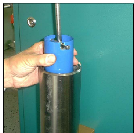
Abb. 3 - Filterpatrone aus dem Gehäuse ziehen
