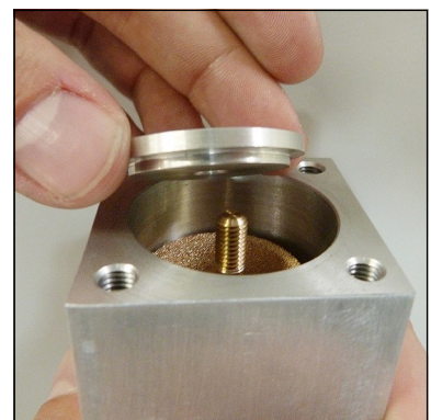
Abb. 5 - Filterscheibe und Unterlegscheibe aufsetzen
