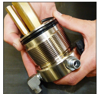
Abb. 4 - O-Ring und Stützring wechseln
