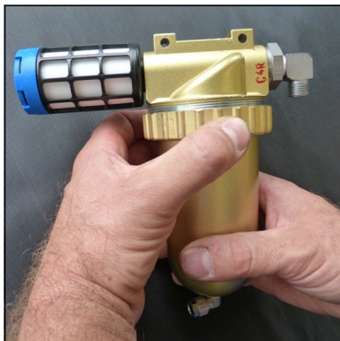
Fig. 1 - Loosen ring nut
